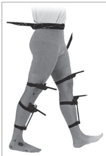
Figura 3. Protocolo de colocación de marcadores. CODAmotion Charnwood Dynamics Ltd. En el protocolo de Análisis de Marcha se utilizan un total de 24 marcadores activos, colocados en la superficie de distintas referencias anatómicas o sobre unas piezas rígidas de fibra de carbono.
